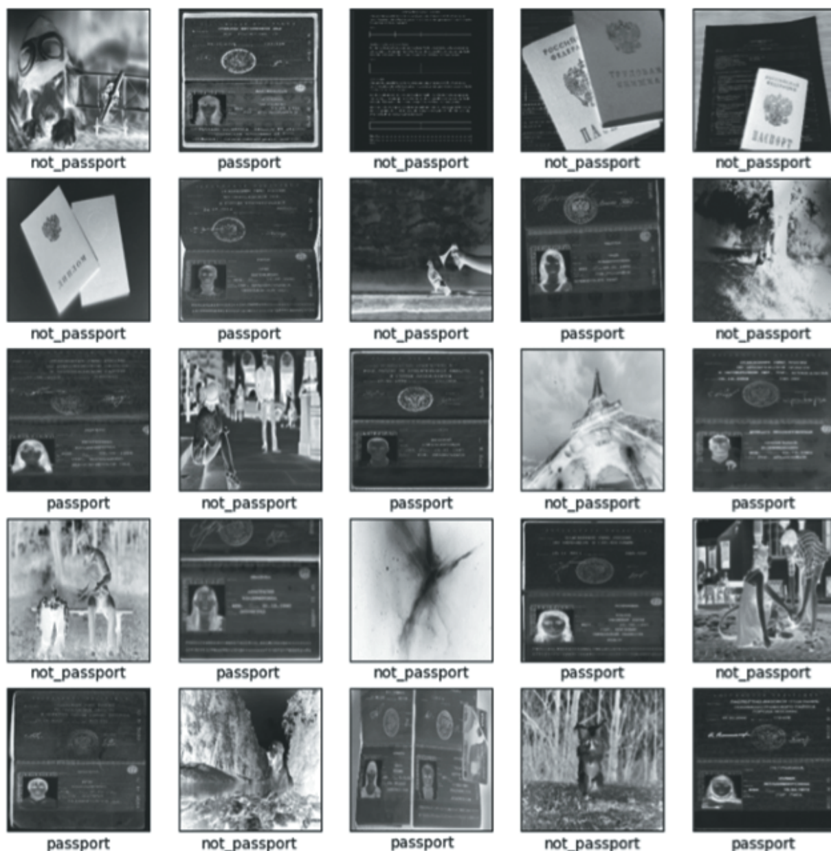
Рисунок 2. Результат работы сверточной нейронной сети по распознаванию вида загруженного документа
