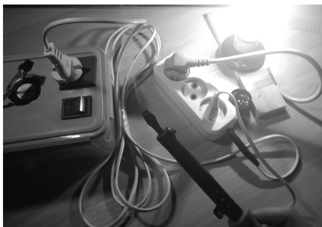
Рисунок 3. Работа разработанного ИПЛИЭ при одновременном подключении лампы накаливания и паяльника
