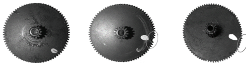
а - шестерня без дефекта; б - шестерни с дефектом (один зуб); в - шестерня с дефектом (три зуба)
