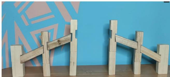
Рисунок 6. Правильная последовательность сборки модели готического собора
