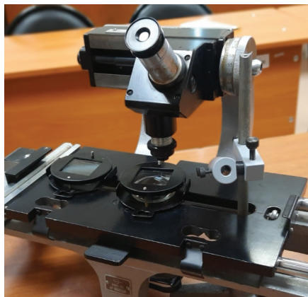
Рисунок 1. Общий вид установки для наблюдения колец Ньютона
