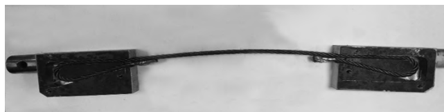
Рисунок 9. Крепление каната в специальных захватах
