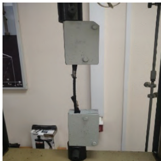
Рисунок 8. Образец стального каната в специальных захватах на машине ИР-5047-50
