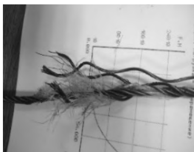
Рисунок 10. Участок каната, не подвергавшийся тепловому воздействию, после испытания на разрыв
