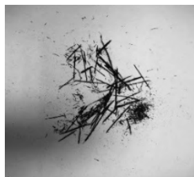
Рисунок 4. Состояние сердечника обследуемого участка каната
