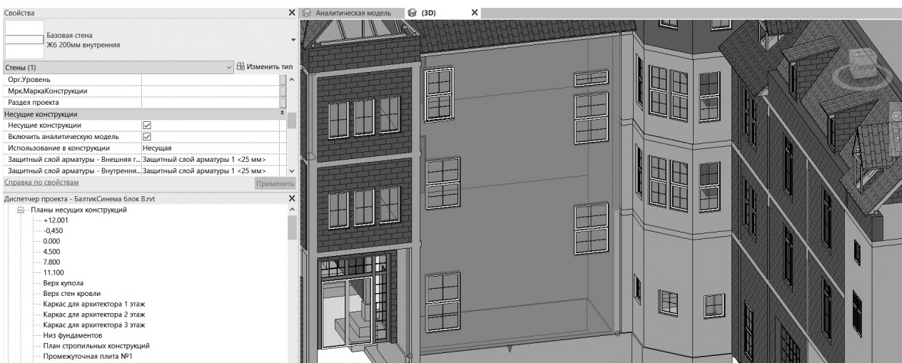
Рисунок 4. Отметка несущих конструкций здания для автоматического создания информационной модели Источник: разработано автором
