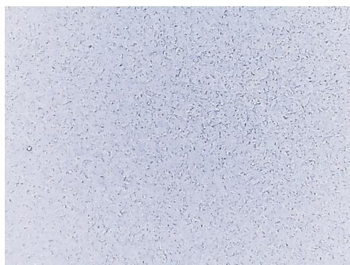
Рисунок 3. Пластина монокристалла кремния; X 200
