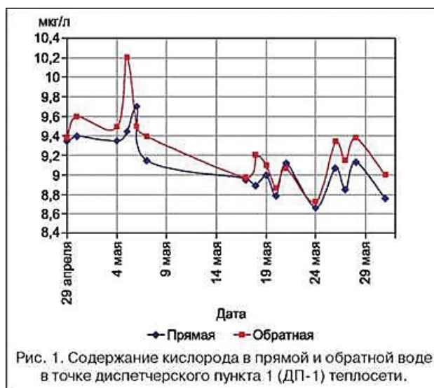
Рисунок 1. Содержание кислорода в подающей и обратной воде на точке диспетчерского пункта Источник: заимствовано из [5]
