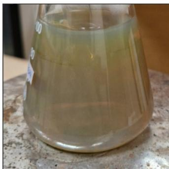
Рисунок 1. Коллоидный раствор наночастиц серебра, синтезированный цитратным методом
