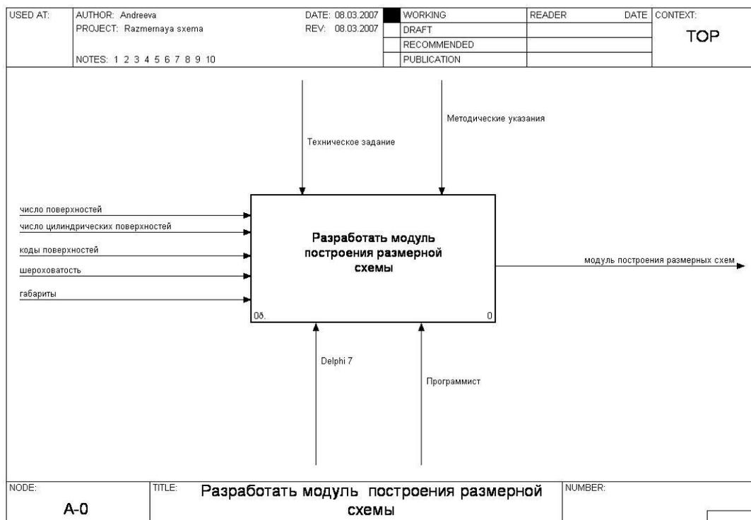
Рисунок 1. Функциональный блок IDEF0 для программы
