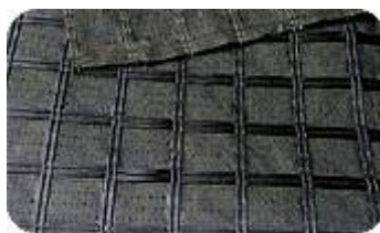
Рисунок 3 – Геосетка HaTelit (Хателит) (Источник: http://www.td-geo.ru/materials/geosetka/mark_geosetki/geosetka_hatelit )
