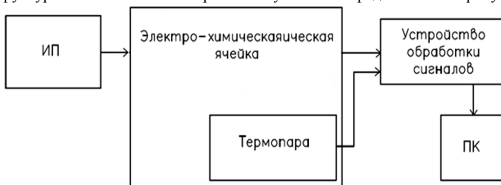
Рисунок 2 – Структурная схема автоматизированной установки
