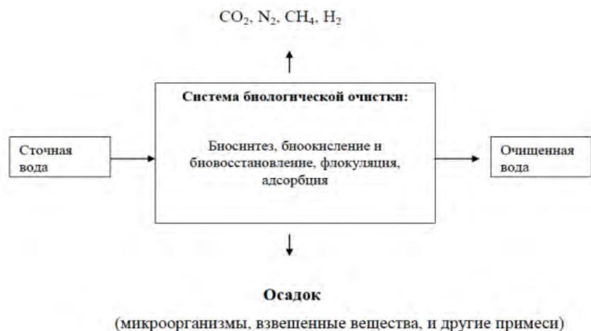
Рисунок 2 – Схема биологической очистки сточных вод
