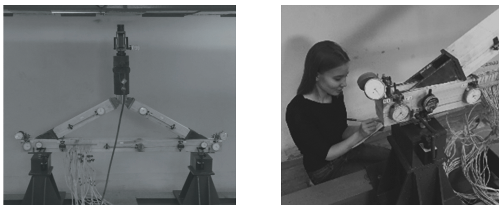
Рисунок 3. Опытный образец, подготовленный к испытанию (а) и снятие отсчетов с контрольных приборов (б)
