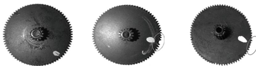
а - шестерня без дефекта; б - шестерни с дефектом (один зуб);
