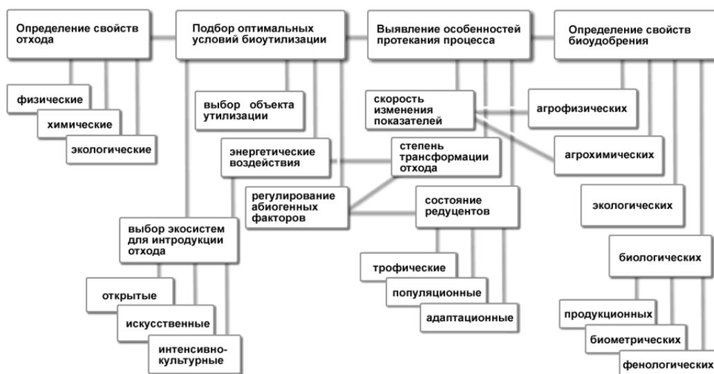
Рисунок 2. Алгоритм проведения биологической утилизации и использования отходов
