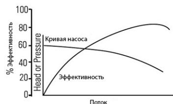
Рисунок 5. КПД насоса с фиксированной скоростью
