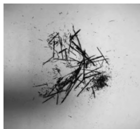
Рисунок 4. Состояние сердечника обследуемого участка каната
