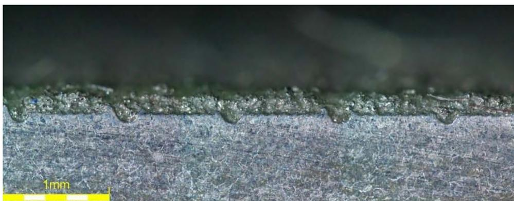
Рисунок 6. Макрофотография образца с покрытием ХН-13 фракцией до 0,315 мм, (X25)
