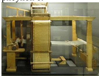
Рисунок 5 – Перфорированная лента для записи программы ткацкого станка
