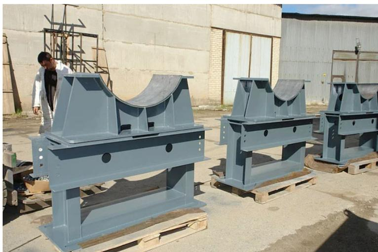
Рисунок 3. Изолированная (диэлектрическая) скользящая опора [4]
